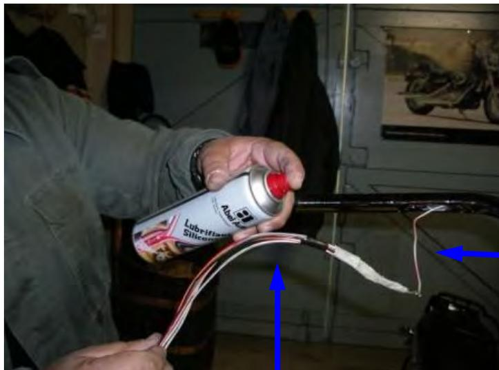
**Pulvériser de silicone le faisceau afin de faciliter le passage dans le Guidon.**
