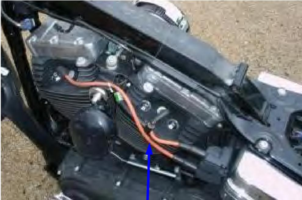
**Débrancher l'arrivée d'essence à l'aide d'un petit tournevis plat en faisant levier, Ça se deconnecte facilement du réservoir et ça ne fuit pas.**
