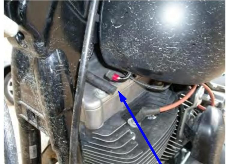
**Débrancher la durite puis boucher la conduite coudée du réservoir.**
